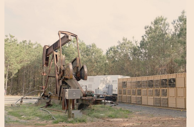
Gas riutilizzato. A Linden, in Texas, il gas disperso da un pozzo petrolifero viene usato per alimentare il mining di criptovalute
